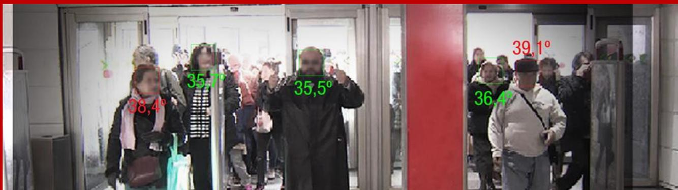
Estas cámaras termográficas poseen un algoritmo muy avanzado y potente en cuanto a medición de temperatura de alta precisión. Además, incorpora inteligencia artificial basada en detección facial. Esto ayuda a poder filtrar cualquier tipo de falsa alarma generado por otros emisores de calor (cigarrillos, cafés, bombillas, etc).
